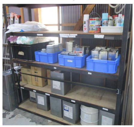
気温の高いコンプレッサー室に有機溶剤を保管しており、 危険なため保管場所を下屋に変更。保管方法は改善予定。
